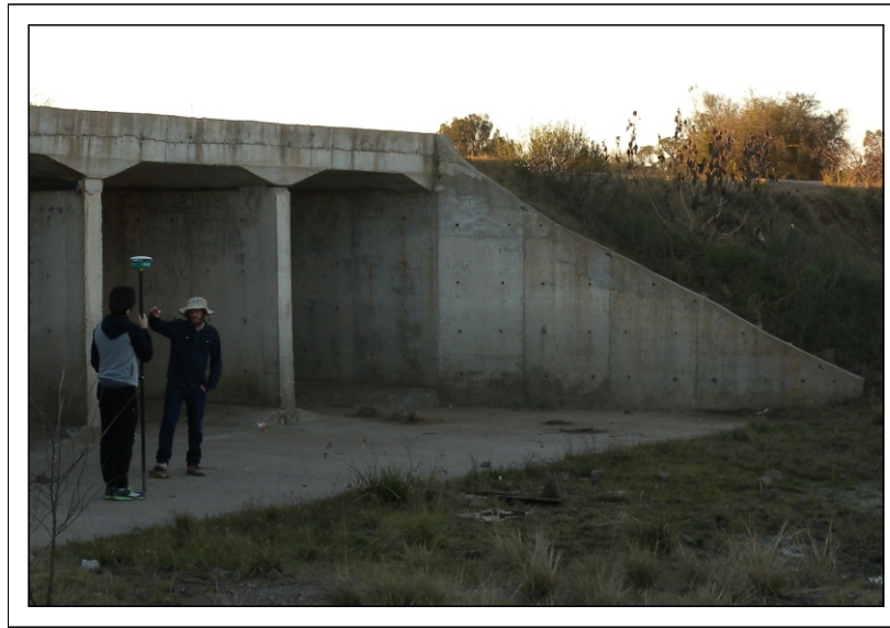
Figura 4.2 – Coleta de pontos altimétricos com GPS de precisão
