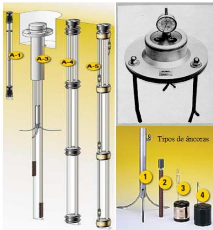
Figura 27 – Exemplo de extensômetro de haste
