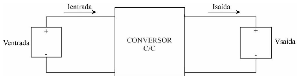
Figura 9 – Representação simplificada de um conversor CC-CC.
