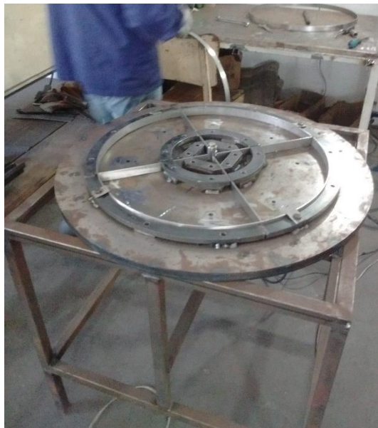
Figura 8 - Exemplo de gabarito para solda de anéis de corte aplicável ao processo
