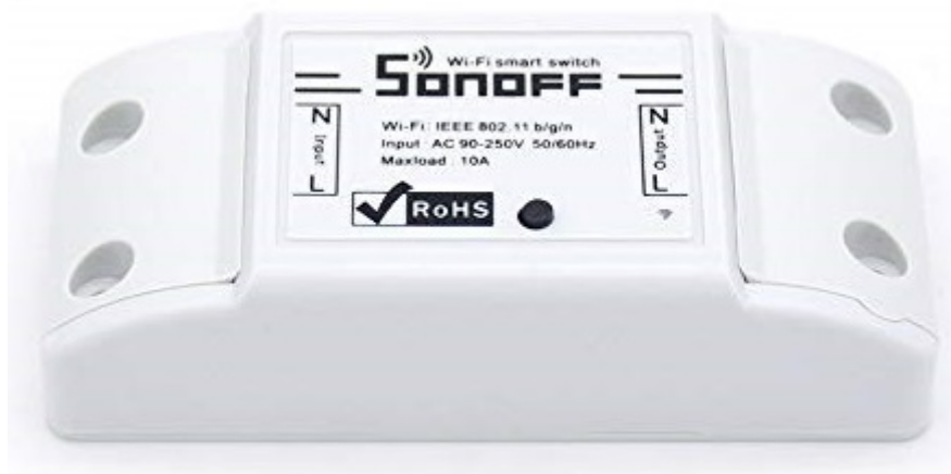
Figura 2.5 – Relé SONOFF básico.
