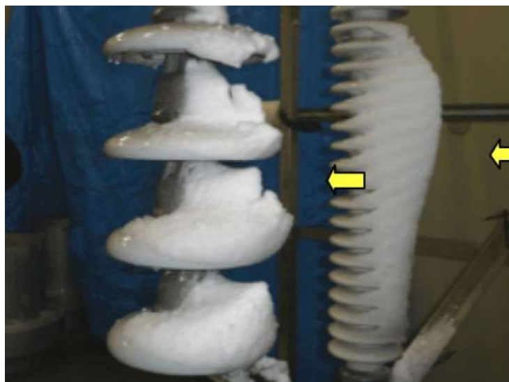
Figura 4.6 – Comparação entre isoladores tipo disco e isoladores de haste longa
