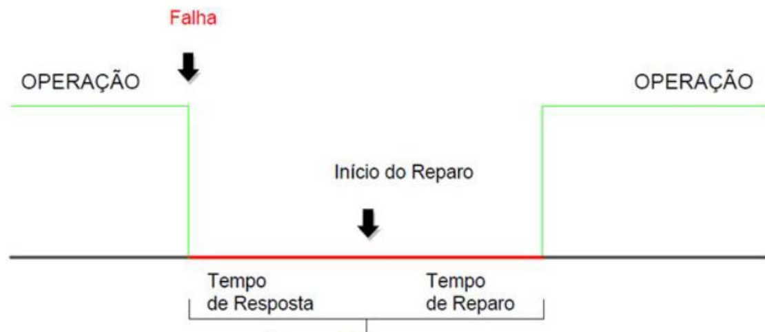
Figura 2 - Operação manutenção corretiva
