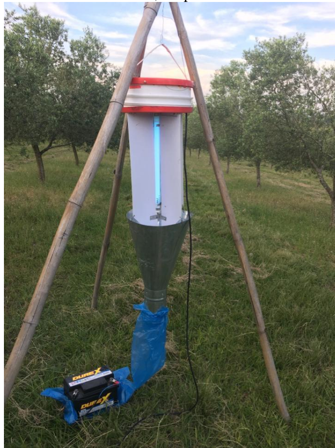
Figura 3.2 – Armadilha luminosa, adaptada do modelo Luiz de Queiroz.
