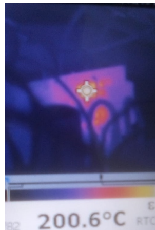
Figura 6.7 – Imagem térmica módulo GaN com Totem Pole PFC operando em 360 W.
