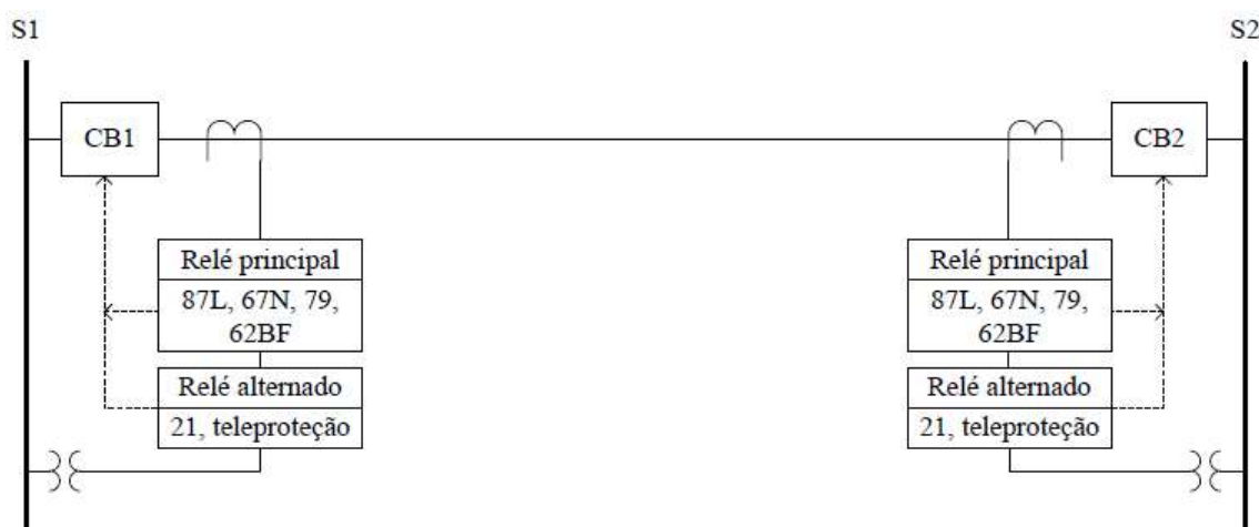
Figura 5.2 – Proteção da linha de transmissão de 230 kV
