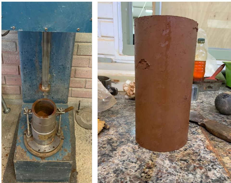
Figura 9 - Ensaio de Compactação do solo e amostra compactada
