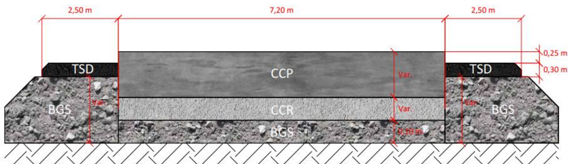
Figura 7 – Seção transversal para o cálculo dos quantitativos de estrutura em concreto simples
