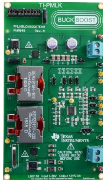
Figura 2 – Conversor buck-boost para ensino da Texas Instruments
