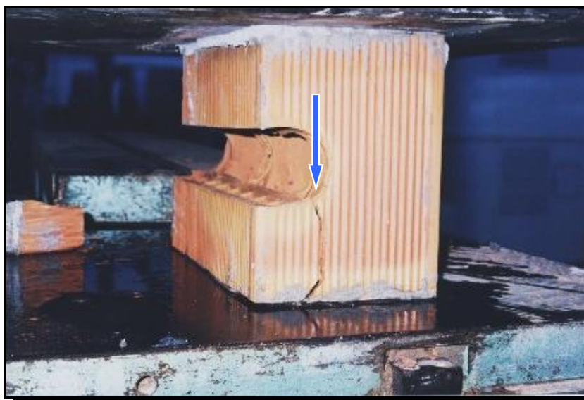
FIGURA 4.21 – Ensaio de resistência à compressão axial de bloco cerâmico especial, com vazado horizontal para a passagem de tubulações.
