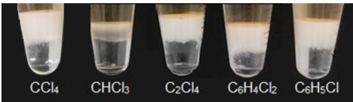
Figura 3 - Efeito do tipo de solvente extrator sobre a formação da fase sedimentada. Condições: 10 mL de cerveja, 500 \mu L de solvente extrator, 3 min de centrifugação a 3000 rpm
