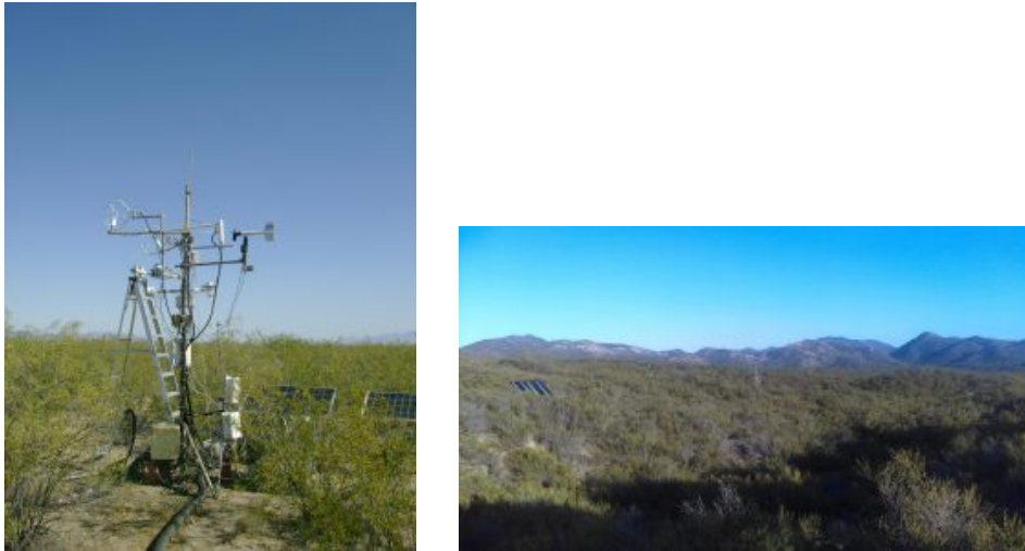
Figura 4.10 – Torre micrometeorológica em superfície arbustiva no sítio US-SRC (Fig. 4.11 lado esquerdo). Superfície estrato arbustivo relativamente denso .(Fig. 4.11 lado direito)
