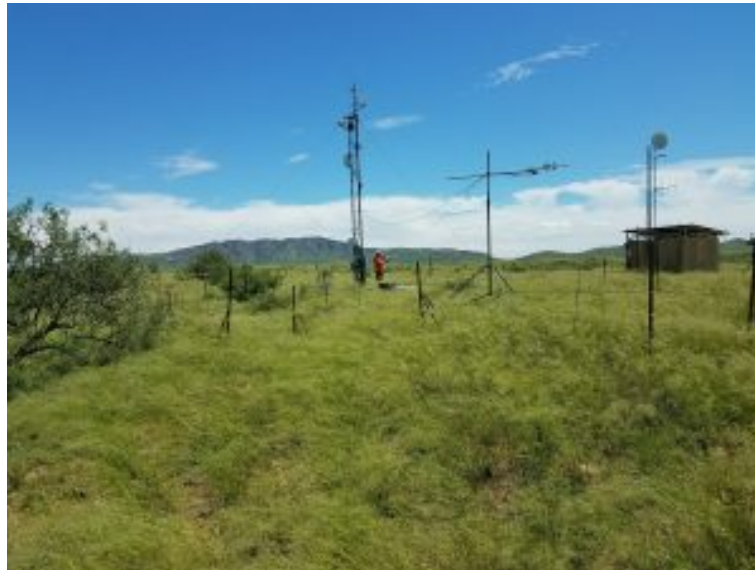
Figura 4.3 – Torre micrometeorológica do sítio US-WKg. De acordo com a a classificação os Sítios US-FPe, US-Seg,e US-Let são sítios classificados como Pastagem.
