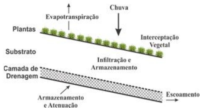
Figura 5 - Atuação do telhado verde no controle quantitativo do escoamento.
