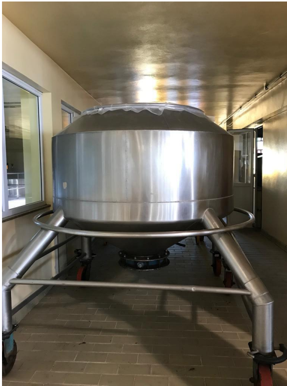
Figura 39: Aranha, equipamento de transporte das bagas.
