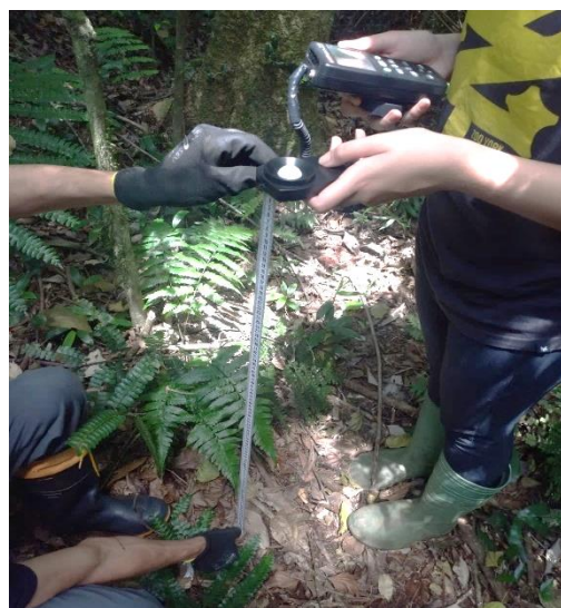
Figura 8 - Medição de índice de luminosidade (lux) com luxímetro digital a 1,0 metro de altura do solo
