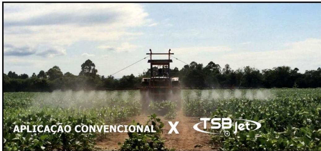
Figura 11 - Comparativo de aplicação convencional (lado esquerdo) versus aplicação com tecnologia de pulverização eletrostática TSBJet (lado direito).
