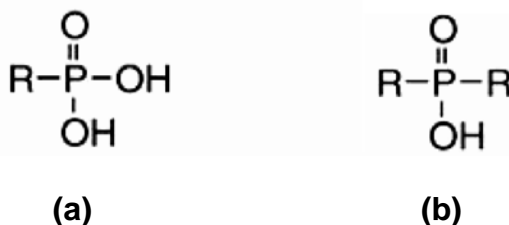
Figura .1. Fórmula estrutural dos principais ácidos organoxifosforados: (a) ácido fosfônico e (b) ácido fosfínico.
