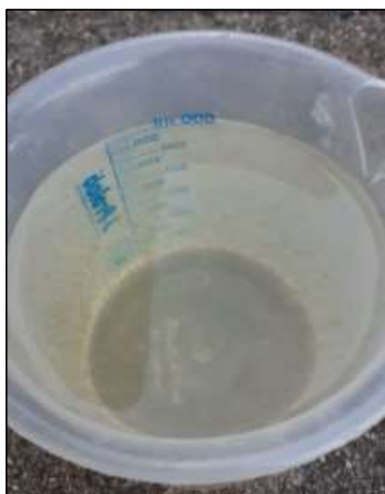
Figura 8 - Flocos formados nas condições de vazão de 25 L/min e gradiente de velocidade de 487 s^{-1}
