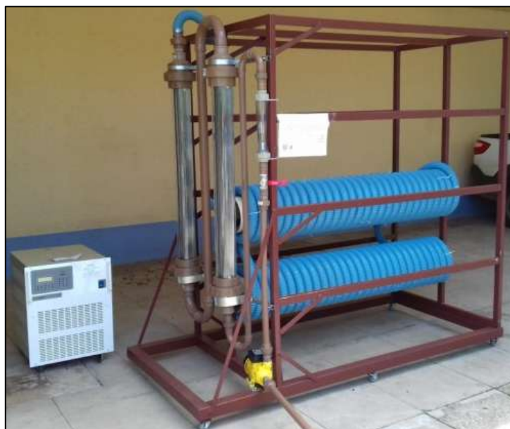
Figura 7 - Sistema ECF em escala piloto instalado nas dependências da CORSAN, em Santa Maria. Constituído por uma fonte de energia, 2 reatores ECF, 2 módulos FTH, 1 rotâmetro e 1 bomba periférica
