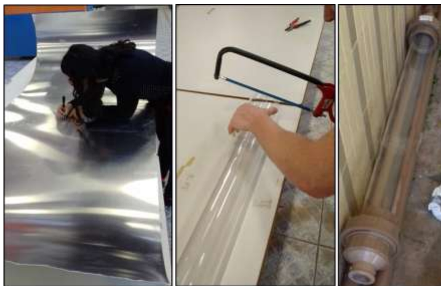
Figura 2 - Construção do reator ECF
