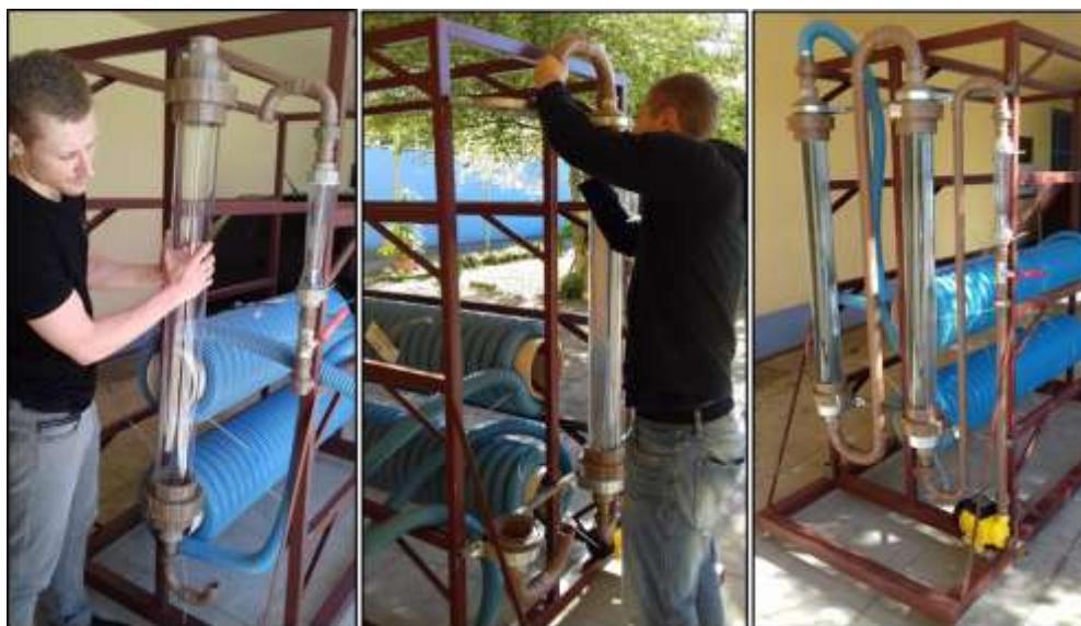
Figura 7 - Sistema ECF em escala piloto instalado nas dependências da CORSAN, em Santa Maria. Constituído por uma fonte de energia, 2 reatores ECF, 2 módulos FTH, 1 rotâmetro e 1 bomba periférica
