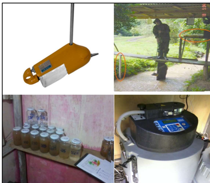
Figura 25 – Coleta de sedimentos por amostradores UDH48 e ISCO 6712
