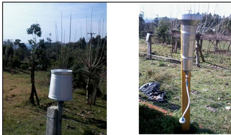
Figura 23 - Pluviógrafo e pluviômetro
