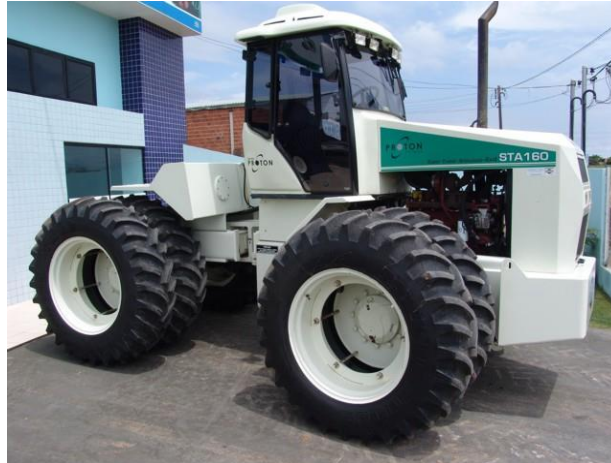
Figura 4 - Estrutura de chassi articulado
