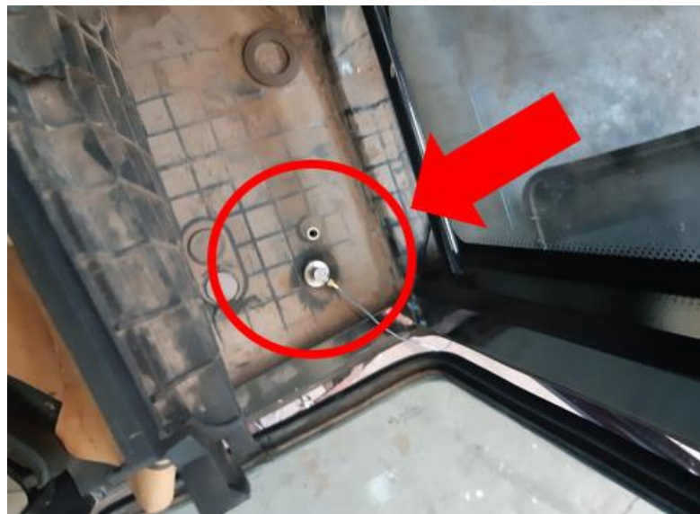
Figura 21 - Acelerômetro localizado na parte superior do coxim
