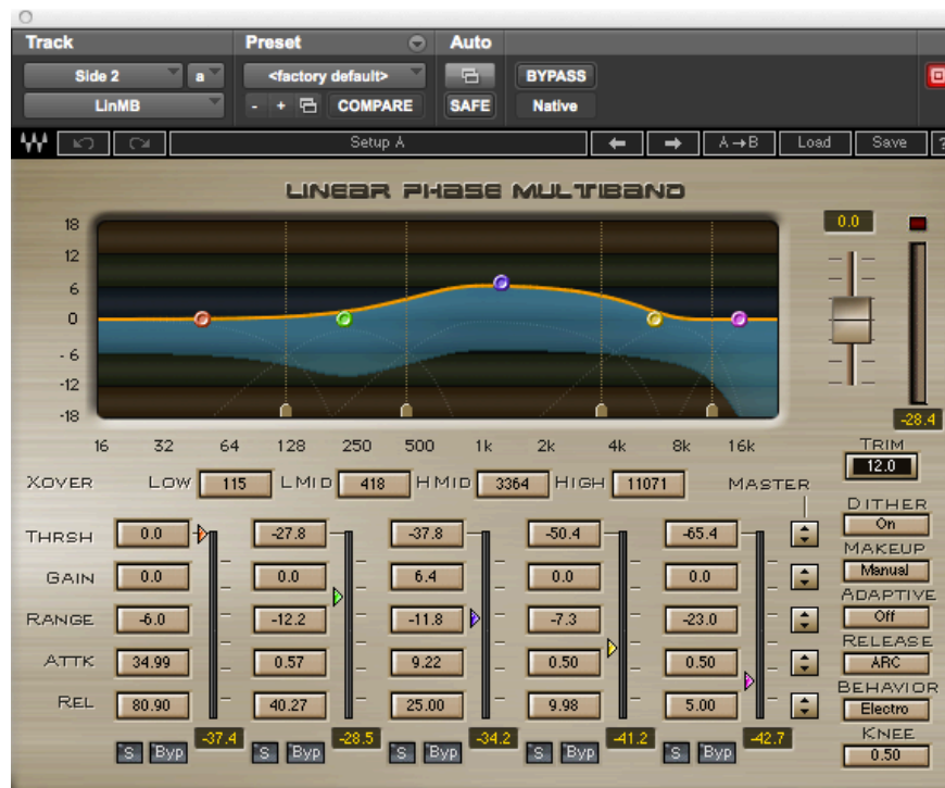
Figura 22 – Compressor multibanda LinMb inserido no microfone do Side do segundo violão (Captura de tela)
