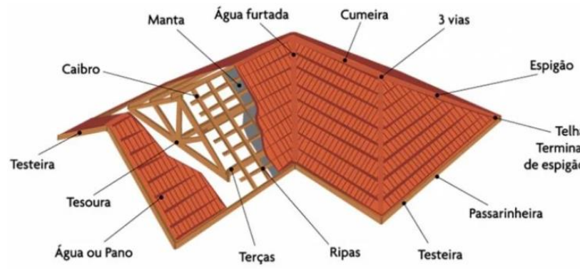
Figura 11: Componentes de um telhado
