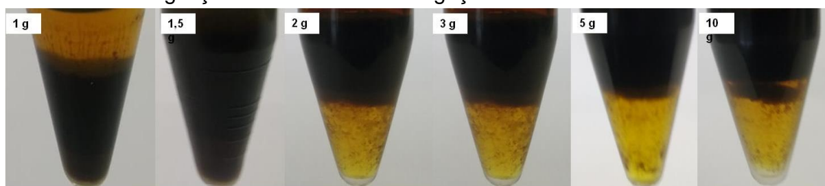
Figura 27 – Aspecto da separação das fases obtidas por RP-DLLME. Condições: 20 min em 75°C, 1,0 mL da mistura de solventes extrator/dispersor, 1 min de agitação e 30 min de centrifugação.
