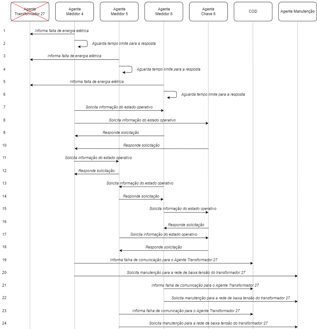
Figura 36 – Diagrama de comunicação da arquitetura descentralizada para o caso 2 com falha de comunicação no Agente Transformador 27
