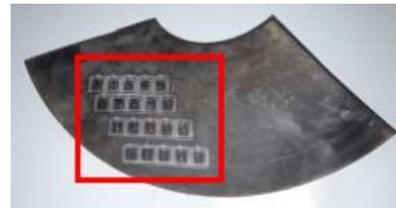
Figura 2. Parte do helicóide com a posição de extração dos CPs.
