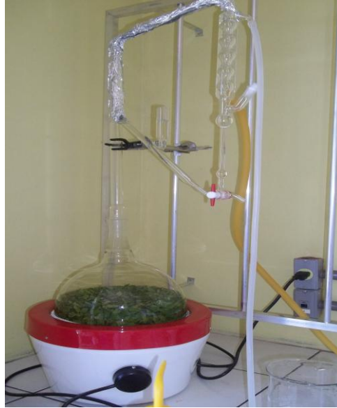
Figura 2. Extração de óleo essencial de Aloysia triphylla utilizando clevenger modificado. Frederico Westphalen, RS, 2012.
