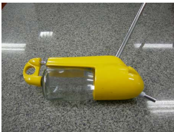
Figura 12 - Amostrador de sedimento em suspensão US DH-48. (Foto: Sequinatto, L.).
