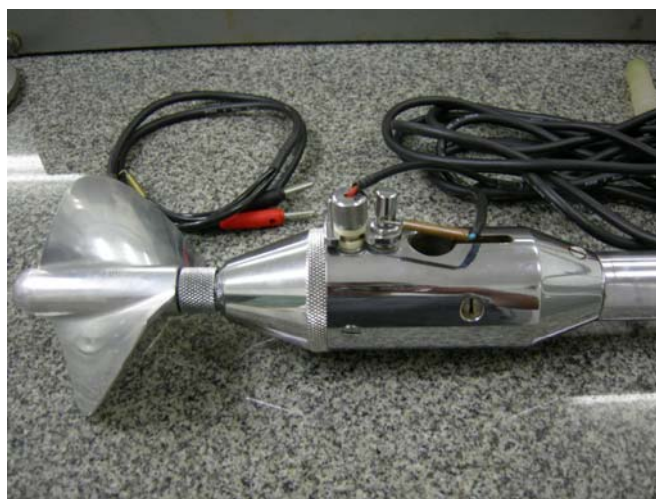
Figura 6 - Molinete para medição de velocidade de fluxos no riacho da pequena bacia hidrográfica rural do Arroio Lino de Nova Boêmia, Agudo – RS. (Foto: Sequinatto, L.).
