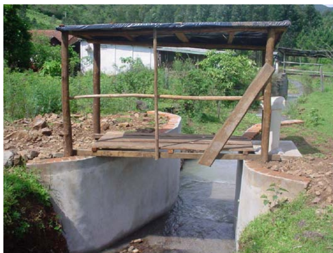
Figura 9 - Imagem da secção de avaliação (calha) localizada no braço esquerdo da pequena bacia hidrográfica rural do Arroio Lino de Nova Boêmia, Agudo – RS. (Foto: Sequinatto, L.).
