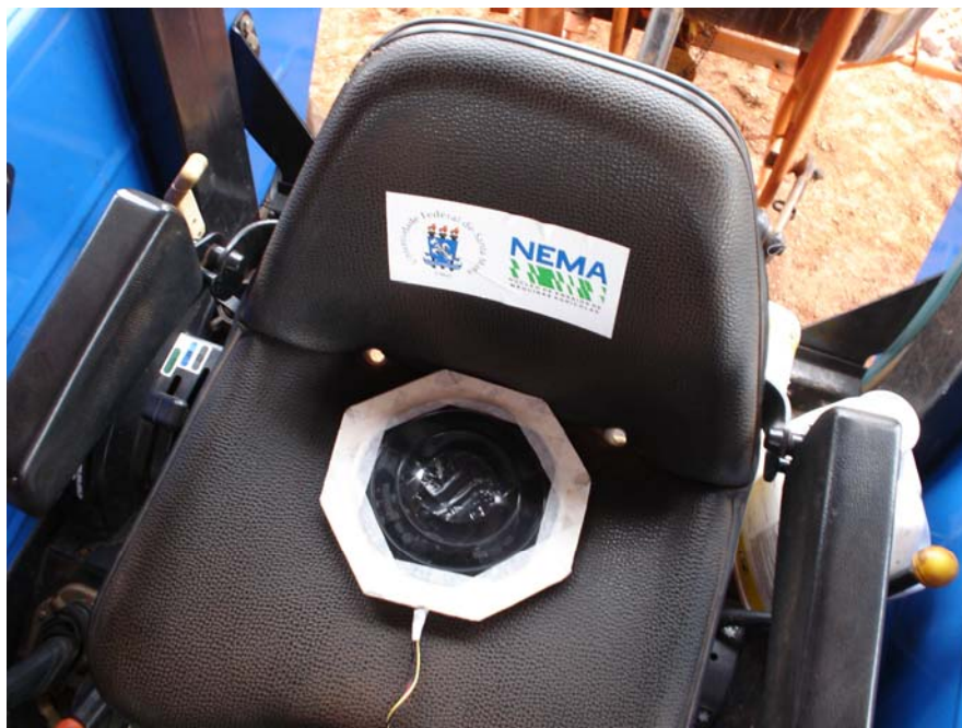
Figura 3.9 – Forma de colocação do acelerômetro no assento.
