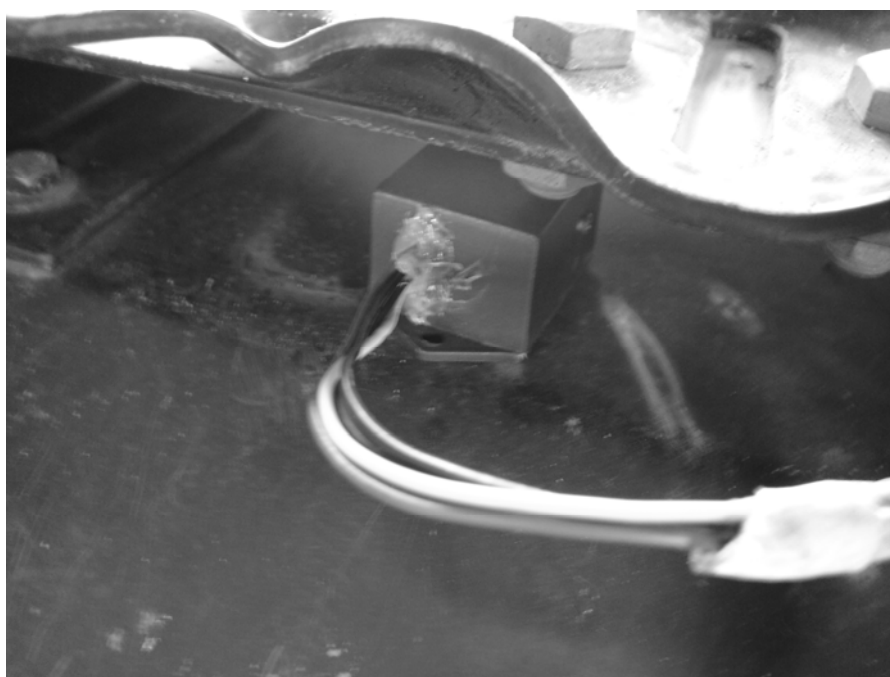
Figura 3.10 – Forma de colocação do acelerômetro na base do assento.
