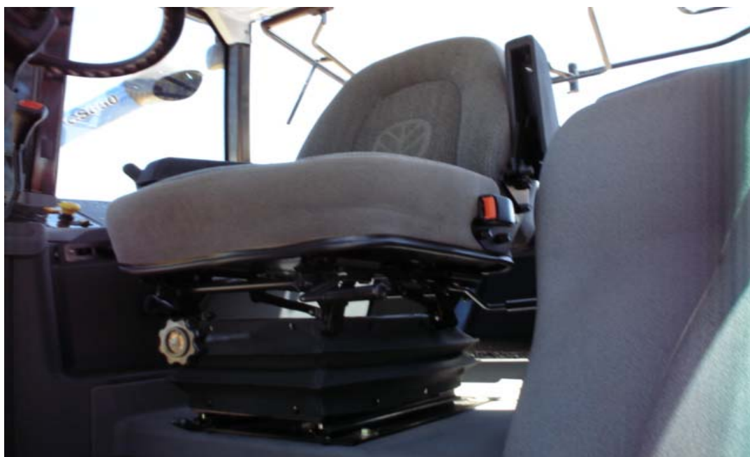
Figura 2.4 – Assento com ajuste e amortecimento.
