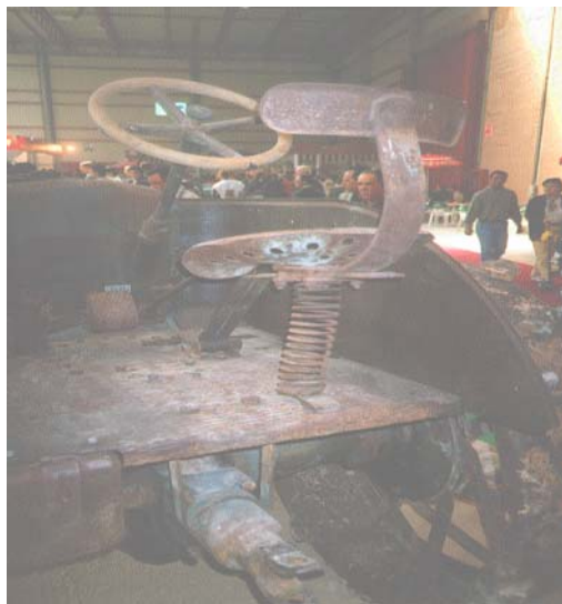
Figura 2.11 – Posto de operação de um trator agrícola antigo (Espanha).
