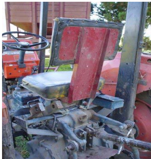
Figura 2.12 – Assento sem sistema de amortecimento (Argentina).
