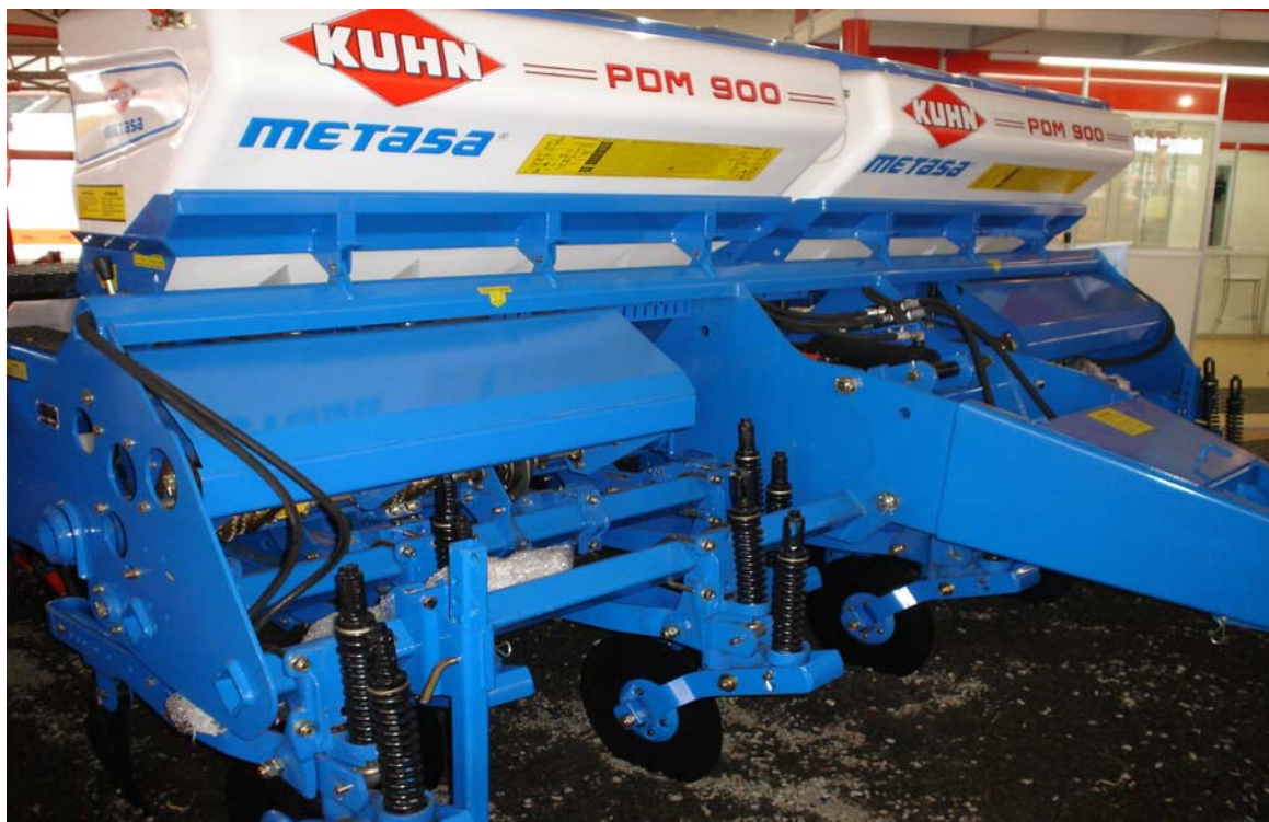
Figura 3.11 – Vista geral da máquina para semeadura e adubação.
