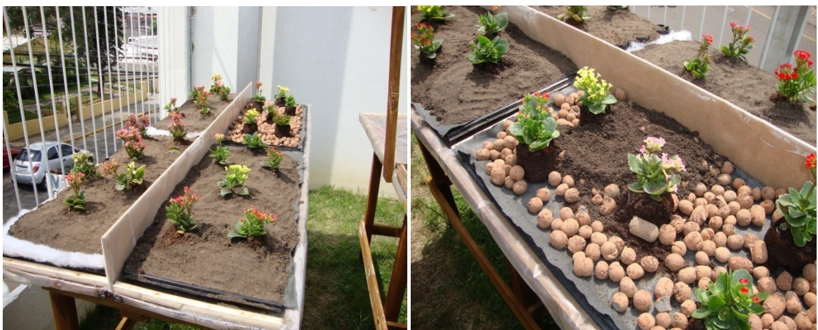
Figura 17 – Montagem inicial dos sistemas alveolares simples e grelhado com e sem argila expandida utilizando plantas da espécie Calanchôe.
