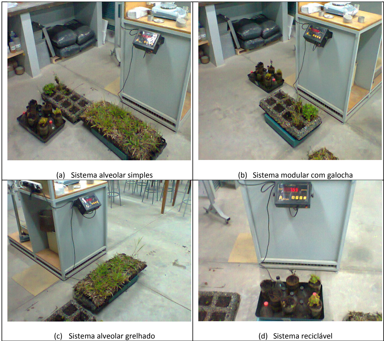
Figura 21 – Esquema de pesagem dos diferentes sistemas de telhado verde utilizados no experimento.
