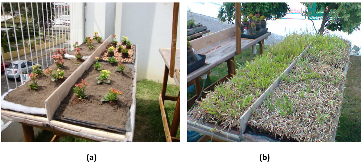
Figura 19 – Sistemas alveolares antes (a) e depois (b) da substituição da vegetação de plantas Calanchôe por grama São Carlos.
