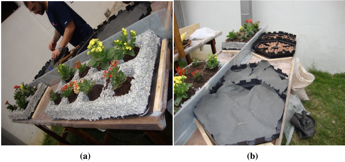
Figura 18 - Montagem dos sistemas galocha (a) e hexagonal (b) com e sem argila expandida.
