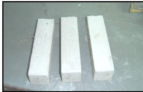
FIGURA 3.17 – Corpos-de-prova desmoldados.
