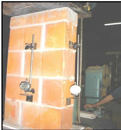
FIGURA 2.9 – Extensômetro mecânico comparador fixo com medidores digitais: utilizados nos corpos-de-prova desta dissertação.
