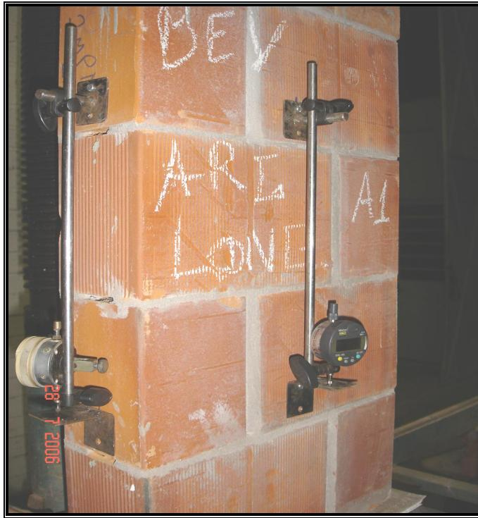
FIGURA 4.2 – Módulo de deformação – dispositivo de ensaio.
