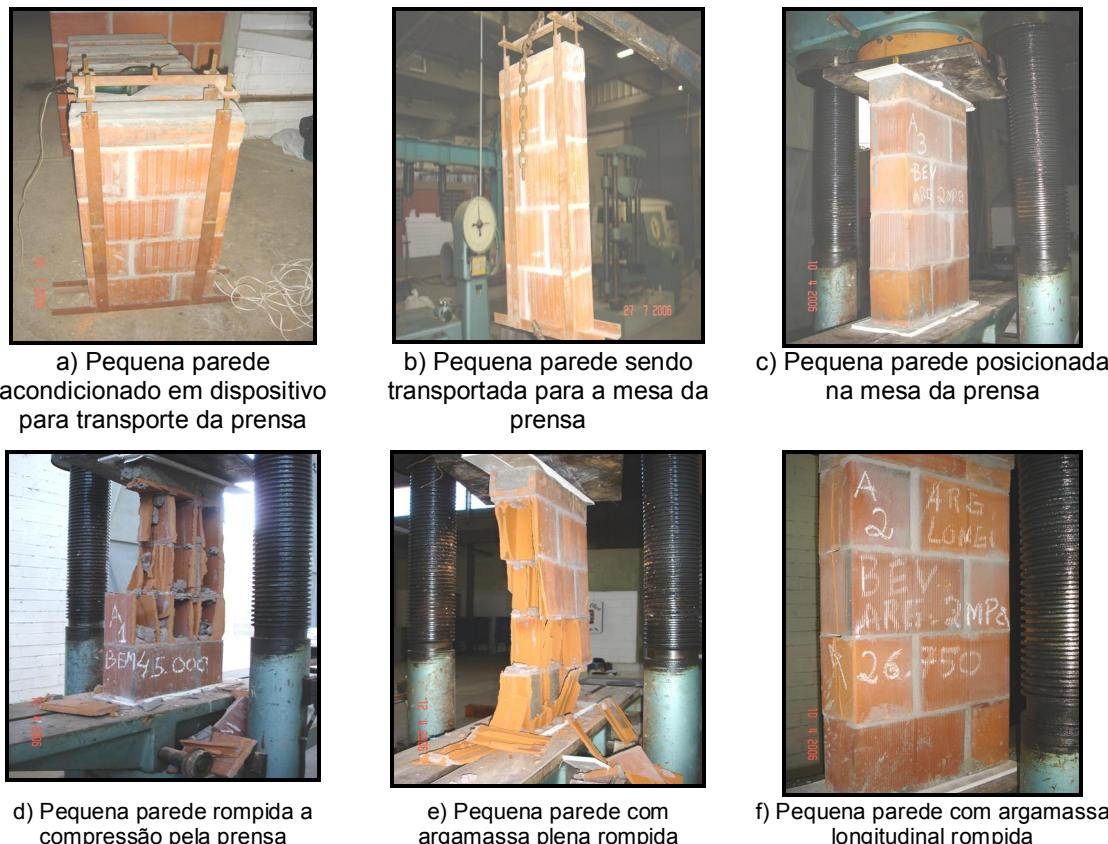
FIGURA 4.1 – Seqüência das pequenas paredes sendo submetidas ao ensaio de resistência à compressão.
