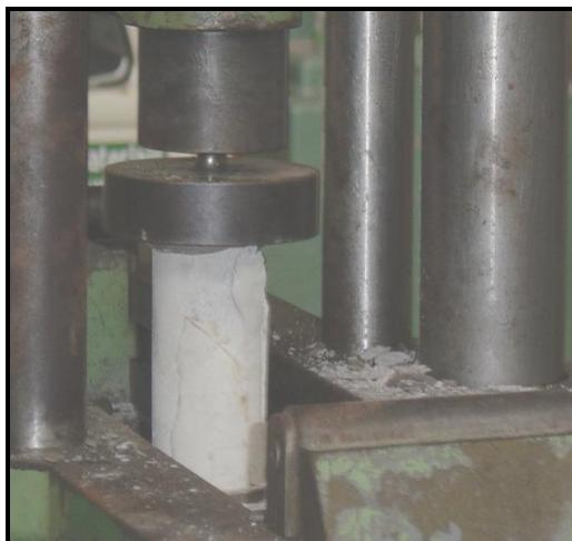
FIGURA 3.14 – Ruptura de corpo-de-prova.
