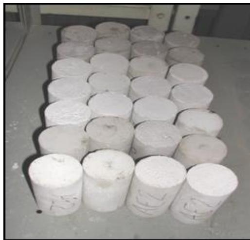
FIGURA 3.13 – Corpos-de-prova cilíndricos de diferentes argamassas.
