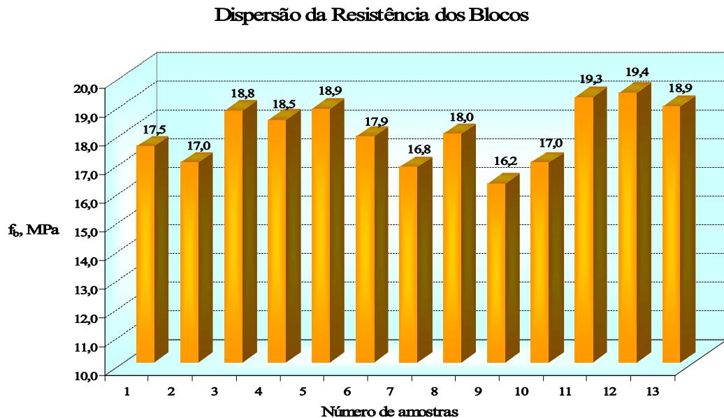
FIGURA 5.2 – Valores das resistências à compressão dos blocos maciços.
