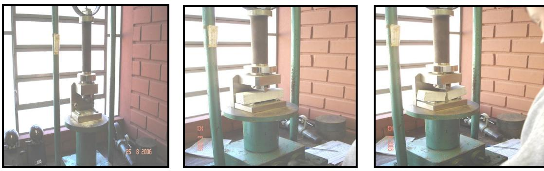
FIGURA 3.18 – Seqüência ensaio de ruptura à tração na flexão.
