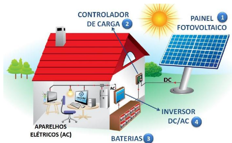
Figura 17 – Sistema Isolado – Off grid
