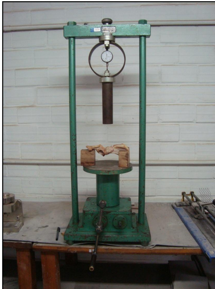
Figura 8 - Prensa de compressão manual e suporte de madeira para adequada acomodação da hemipelve para o teste de flexão.
