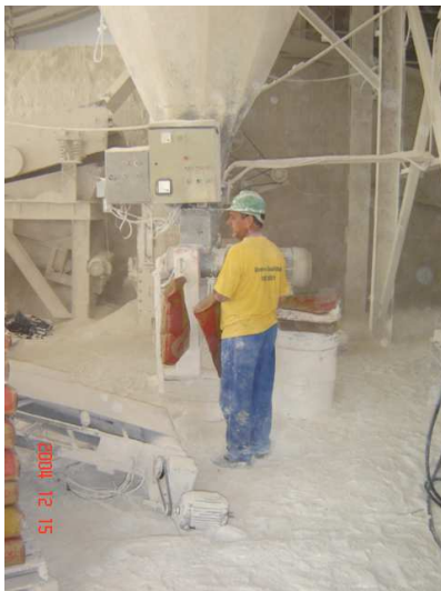
Figura 10 – Ensaque da Cal Moinho 01
