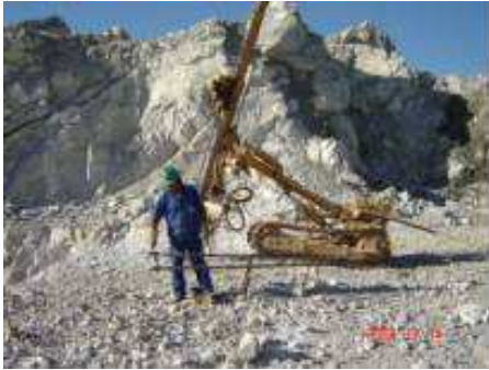
Figura 02 – Lubrificação das Hastes
