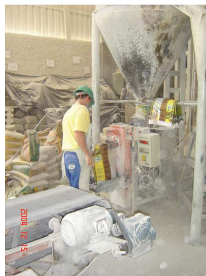
Figura 13 – Ensaque de argamassa
