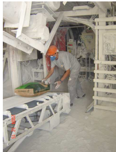
Figura 11 – Ensaque da Cal Moinho 02
