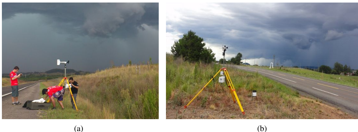
Figura 2.1: Estação Mesomóvel sendo instalada (a) e em funcionamento (b), posicionada à dianteira de uma tempestade convectiva. Fotografias gentilmente cedidas por Nascimento, E. (2012) e Ilha, M. (2012) (respectivamente).
