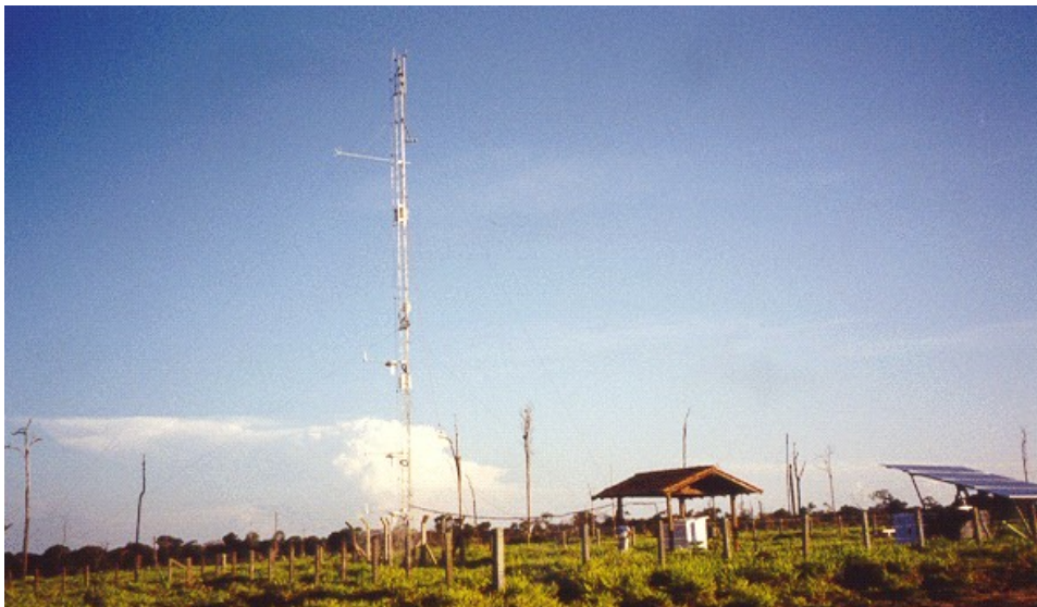
Figura 4.1: Foto do sítio experimental, é possível notar na foto a torre micrometeorológica instalada para as observações in situ .
