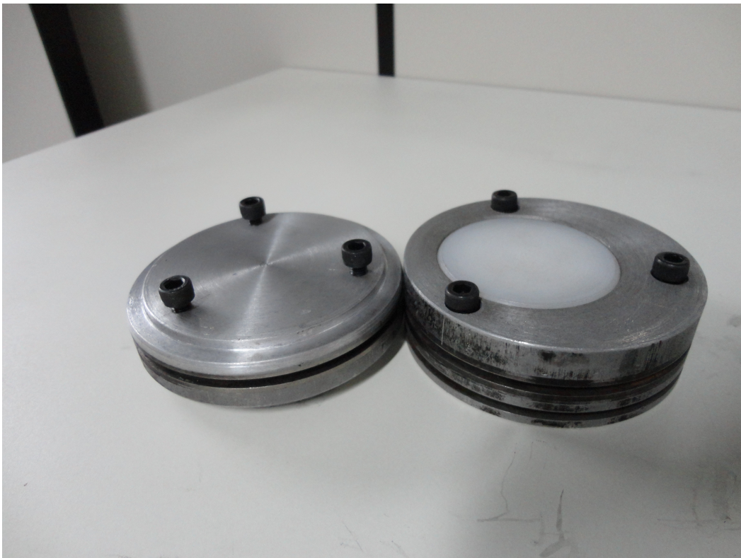
Figura 14 – Vista externa do corpo do protótipo, aberto em duas partes, à esquerda está a base, com três parafusos de fixação semi-apertados, e à direita a parte superior, já com o difusor (parcela circular branca no centro) selado no local definitivo.
