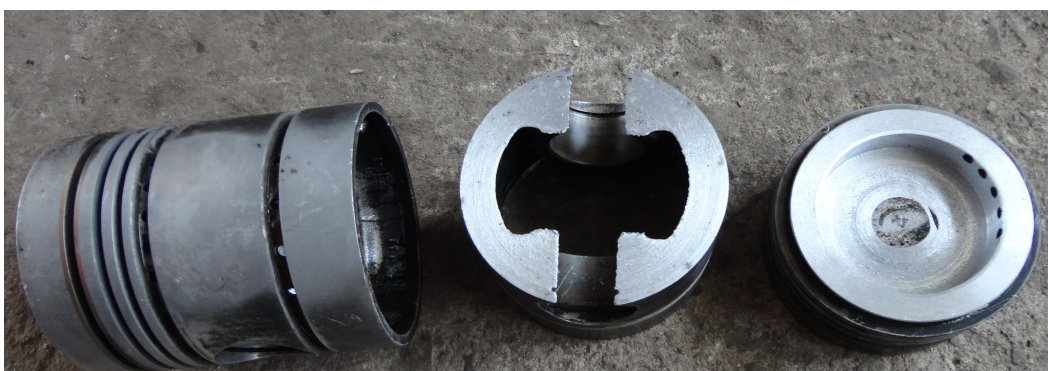
Figura 13 – Fotografia de um pistão inteiro (à esquerda da imagem) juntamente com outro semelhante já cortado em duas parcelas, uma que foi descartada e à direita a parte superior do pistão em processo de usinagem final.
