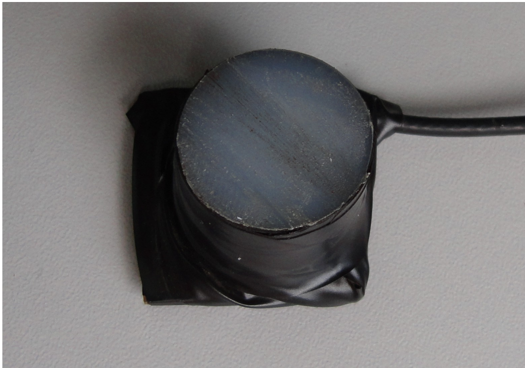
Figura 12 – Fotografia do primeiro protótipo mostrando o fotodiodo encapsulado por um difusor de náilon, formando um simples chassis.
