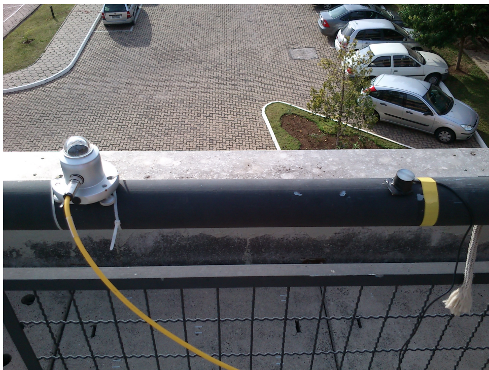
Figura 28 – Fotografia do sensor CMP3, à esquerda (cabo amarelo), e o protótipo com difusor acoplado ao TIL38, à direita, coletando dados no dia 07 de agosto de 2012, nas dependências do INPE – CRS, em Santa Maria – RS, na Universidade Federal de Santa Maria.
