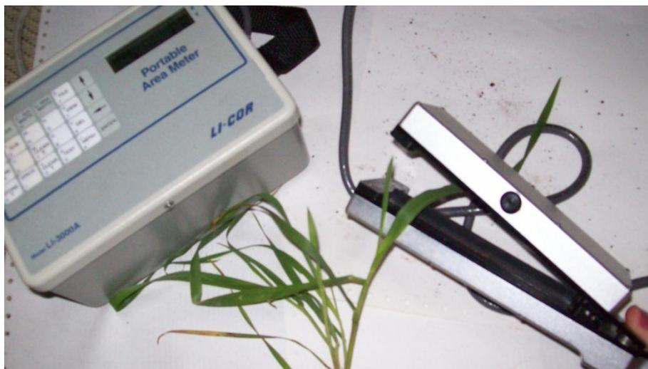
Figura 5 – Equipamento Portable Area Meter Li-Cor Model Li-3000A que mede experimentalmente a área foliar.
