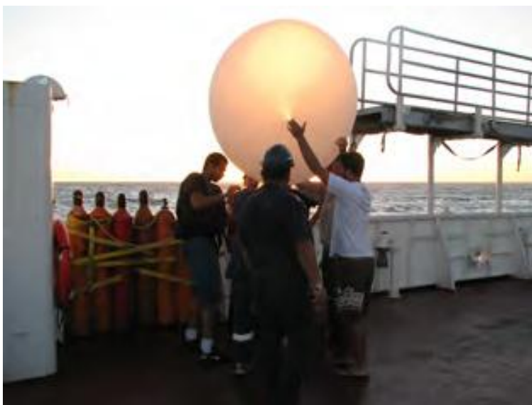
Figura 2.3 – Operação de enchimento do balão (esquerda) e lançamento das radiossondas atmosféricas pelo projeto ACEX a bordo do Navio Oceanográfico Alpha-Crucis.
