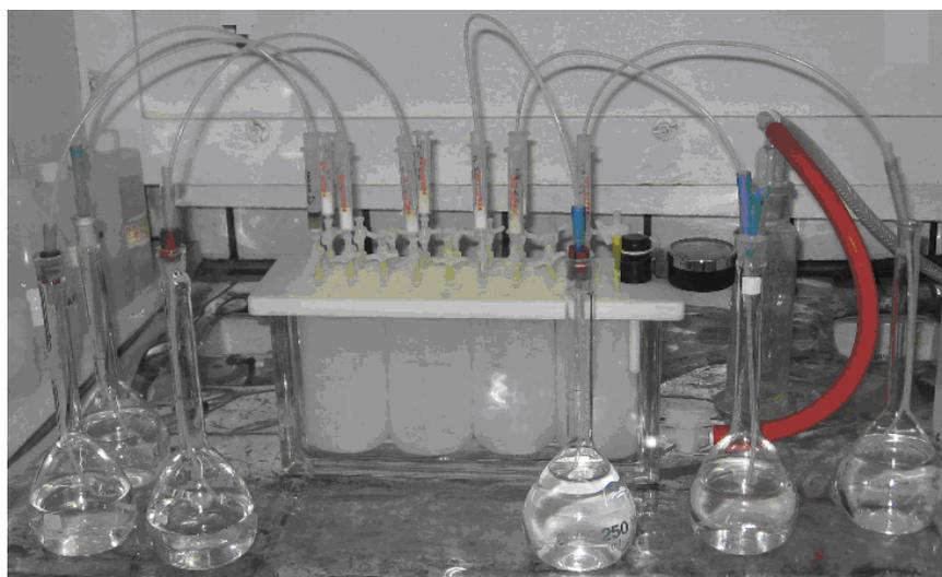
**Figura 8. Foto do sistema SPE utilizado na pré-concentração das amostras de água**
