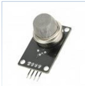
Figura 12 - MQ-2 Sensor de fumaça e gases inflamáveis.
