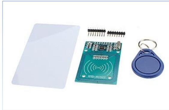
Figura 13 - Modulo RFID Mfrc522 identificador de rádio frequência.
