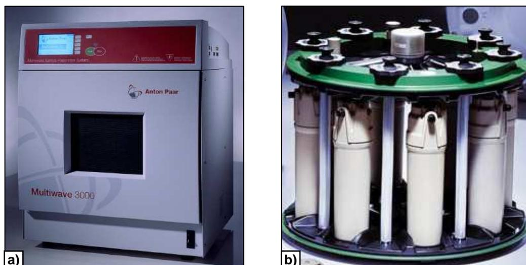
**Figura 7.** (a) Forno de microondas comercial Multiwave 3000<sup>®</sup> e (b) rotor com os frascos de quartzo, utilizados nos procedimentos de decomposição por via úmida e por combustão iniciada por microondas (MIC)<sup>18</sup>
