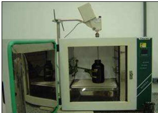
**Figura 13.** Procedimento para homogeneização das amostras de petróleo.
