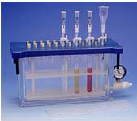
**Figura 2.** *Manifold* para SPE usado para purificação dos extratos.
