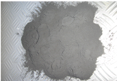
Figura 13 - Cinza de casca de arroz residual utilizada na obtenção das sílicas xerogéis.
