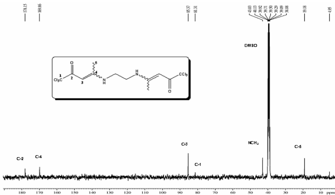
Figura 67: Espectro de RMN ^{13}\text{C} do N,N' -bis(1,1,1-tricloropent-3-en-2-ona)-1,2-diaminoetano ( 10d ) em DMSO a 100Mz.
