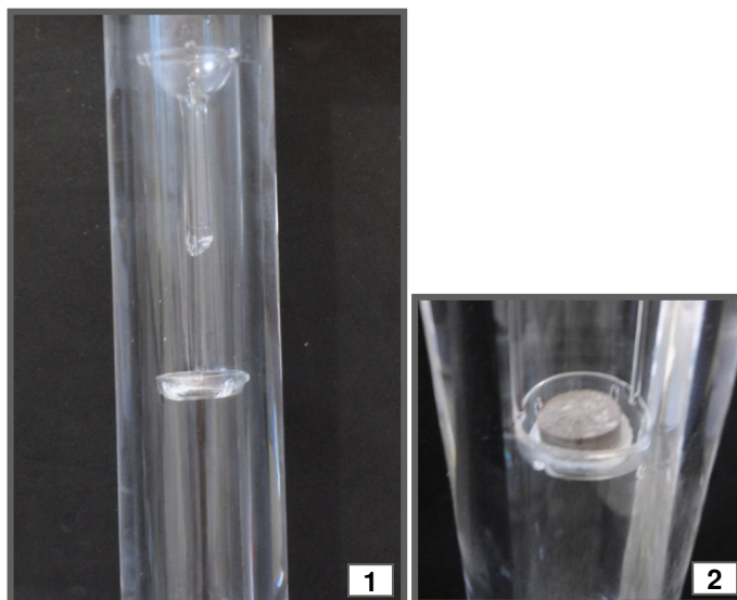
Figura 11. (1) Frasco de quartzo com suporte contendo a amostra de solo para a digestão por MIC (2) imagem aproximada do comprimido de solo e celulose microcristalina.
