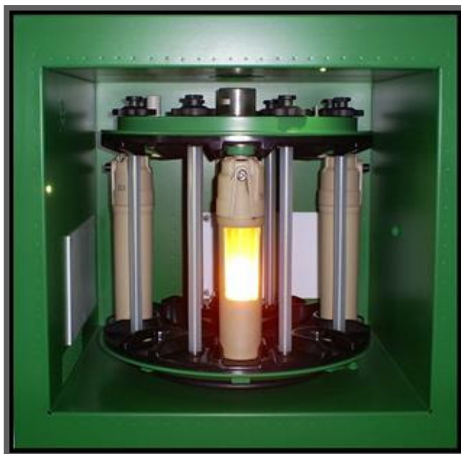
Figura 13. Visualização da combustão de 100 mg de amostra de solo com 500 mg de celulose microcristalina.
