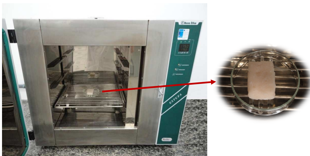
Figura 9. Sistema utilizado para o processo de assagem das amostras. Esquerda: forno estufa; Direita: assadeira de vidro provida com grelha de vidro e amostra.
